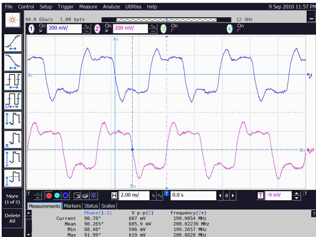
图 5-10 输入 800MHz,4 分频时的正交输出时域波形
