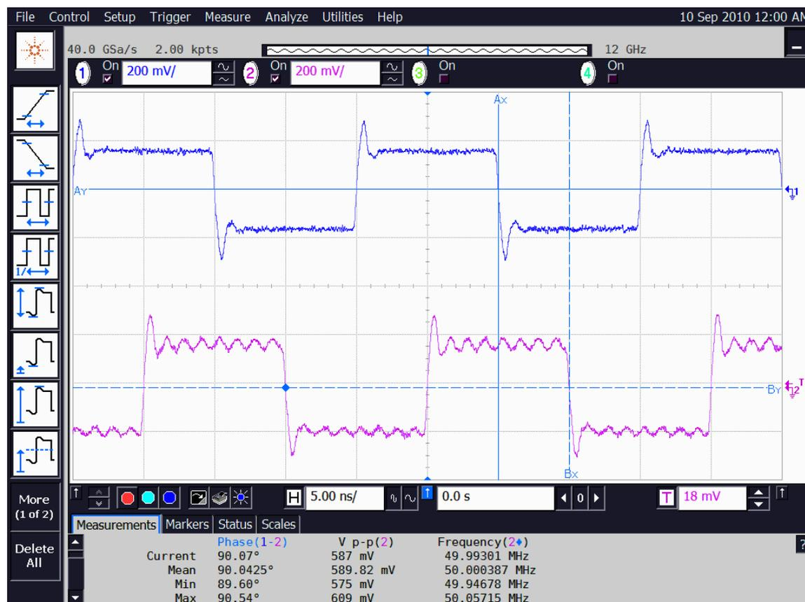
图 5-12 输入 800MHz,16 分频时的正交输出时域波形
