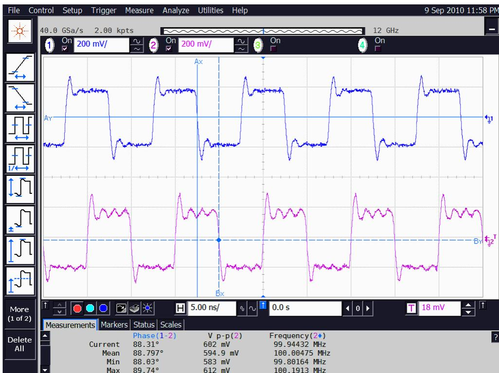
图 5-11 输入 800MHz,8 分频时的正交输出时域波形
