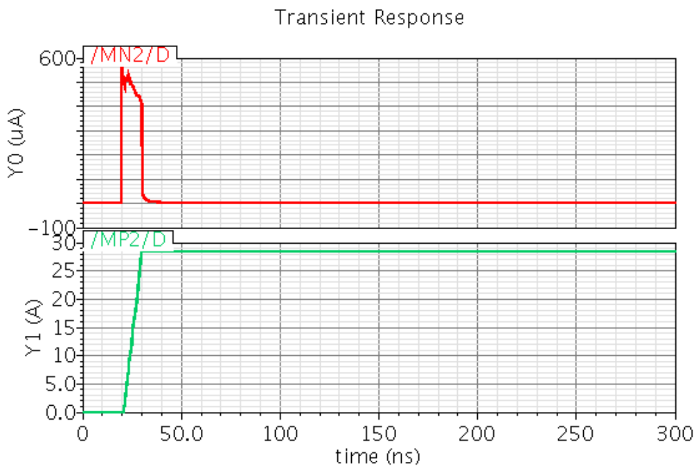
图 4-11 I/p1 对 VDD 正向放电时的仿真
