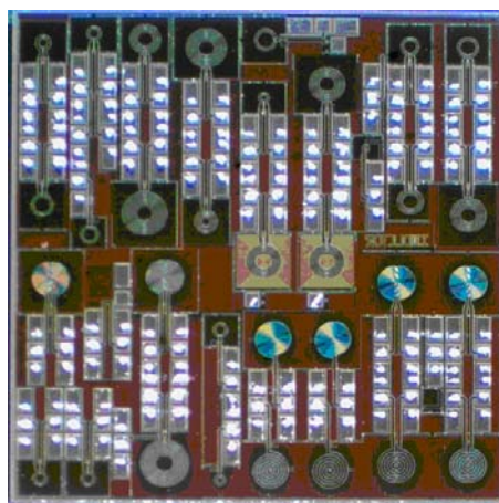
图4.8 0.35 μm两多晶硅四铝的模拟工艺电感芯片版图照片
