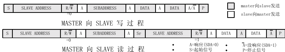
图 2-6 I 2 C 总线通讯过程的定义
