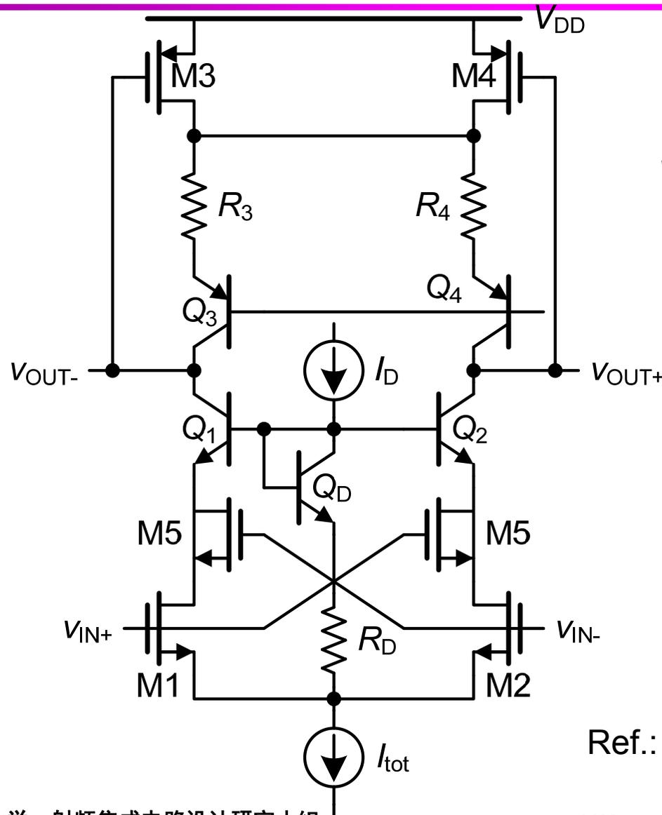
$$V_{DS1} = R_D I_D \approx 0.2 \text{ V}$$
