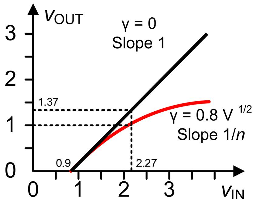
$$V_{T0} = 0.6 \text{ V}; V_{GS0} = 0.9 \text{ V}; 2\Phi_F = 0.7 \text{ V}; B = -0.47 \text{ V}; 1/n = 0.73$$
