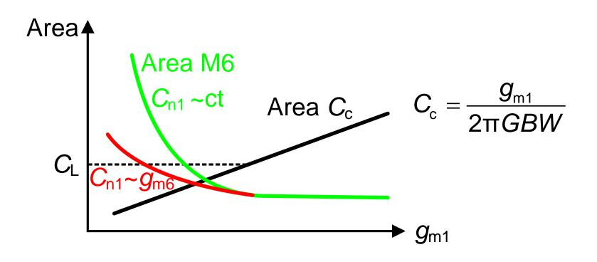
$$g_{\text{m6}} \approx 3GBW \cdot 2\pi C_{\text{Ln4}} \cdot (1 + \frac{C_{\text{n1}}}{g_{\text{m1}}} 2\pi GBW)$$
