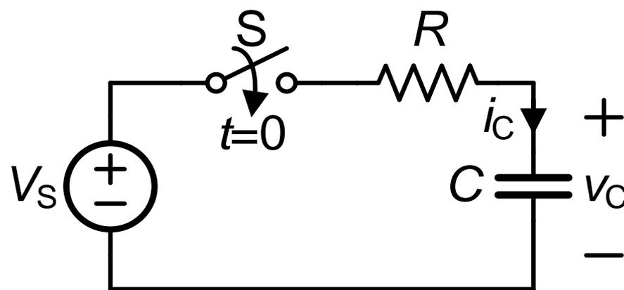
电路结构或者参数变化引起的电路变化称为换路。
