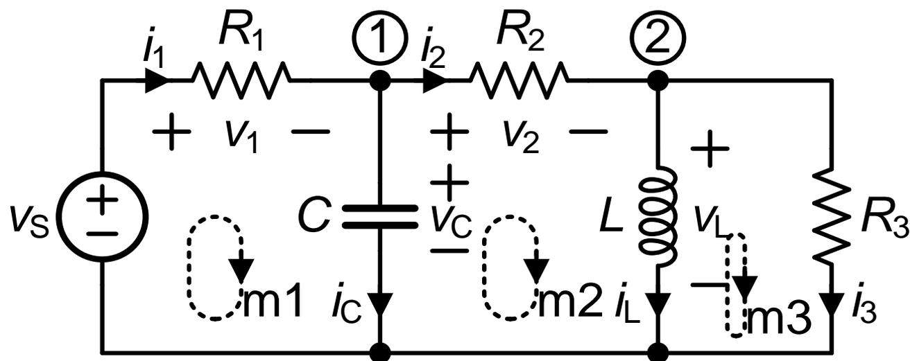
节点1的KCL方程和回路m3的KVL方程，节点2的KCL方程和回路m1和m2的KVL方程
