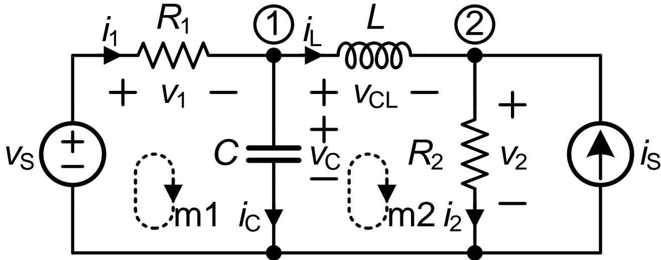
节点1的KCL方程和回路m2的KVL方程，节点2的KCL方程和回路m1的KVL方程
