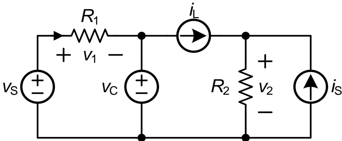
待求变量为  $v_1$  和  $v_2$ ，根据置换定理，分别用电压源和电流源置换电容和电感
