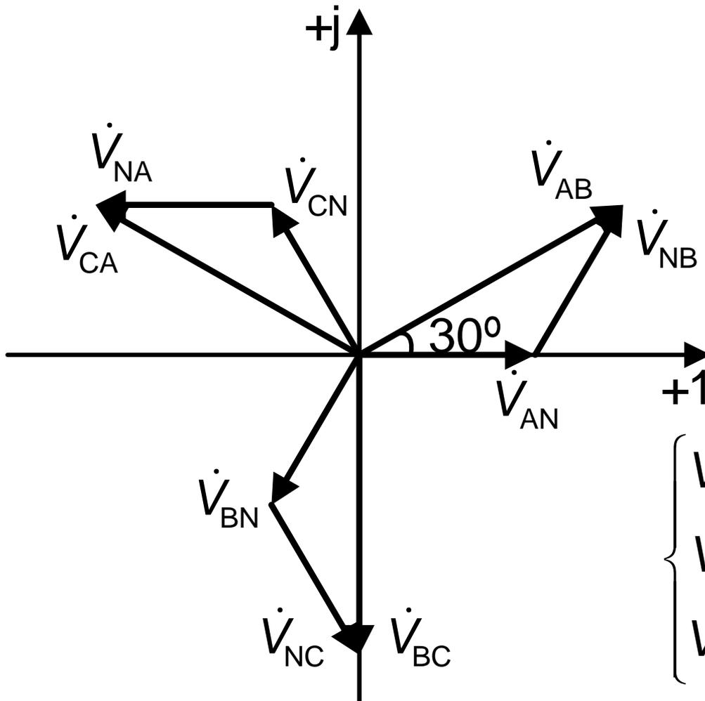
$$\dot{V}_{AB} = \dot{V}_{AN} - \dot{V}_{BN} = \dot{V}_{AN} - \frac{\dot{V}_{AN}}{\alpha}$$
